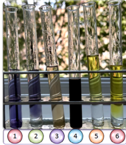
Նկար 5. Ֆենոլի և նրա ածանցյալների ու Fe^{3+} իոնի կոմպլեքսների գունային փոփոխությունները 1) ֆենոլ, 2) ռեզորցին, 3) հիդրոխինոն, 4) պիրոզալոլ, 5) կաթնաթթու, 6) կիտրոնաթթու
