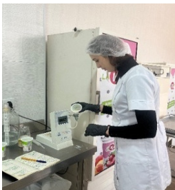
Նկար 4. Կաթի յուղայնության որոշումը կաթի անալիզատորով
