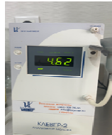
Նկար 4. Կաթի յուղայնության որոշումը կաթի անալիզատորով
