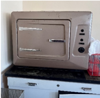
Նկար 9. Կաթի մեջ չոր մնացորդի որոշումը չորացնող պահարանի միջոցով
