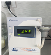
Նկար 4. Կաթի յուղայնության որոշումը կաթի անալիզատորով
