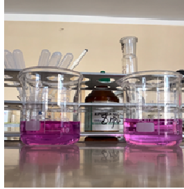
Նկար 6. Կաթի սահմանային թթվայնության որոշումը
