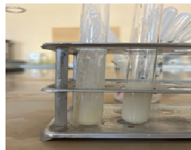
Նկար 7. Կաթի թթվայնության որոշման սպիրտային եղանակ
